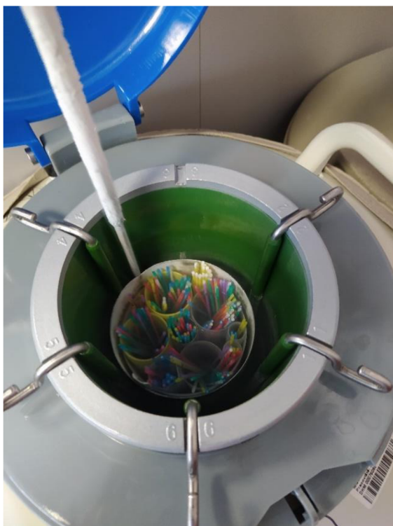
Obrázek 3: Uložení inseminačních dávek v kontejneru s tekutým dusíkem při teplotě -196\text{ }^{\circ}\text{C} (zdroj: archiv autorky)
