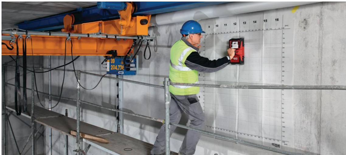
Obrázek 14 Ukázka práce s přístrojem HILTI PS 1000 [35]
