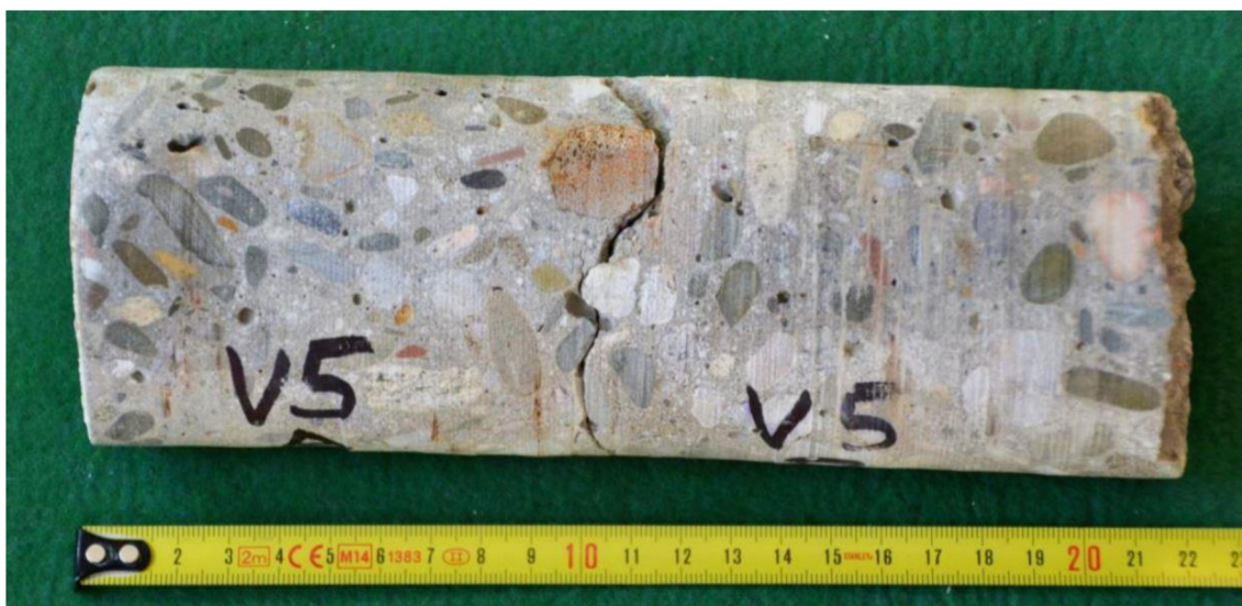
Obrázek 2 Označení a dokumentace jádrového vývrtu [15]
