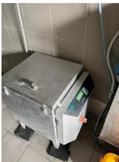
Obrázek 4.1: Stroj na ohřívání mleziva (Wendl, 2023)
