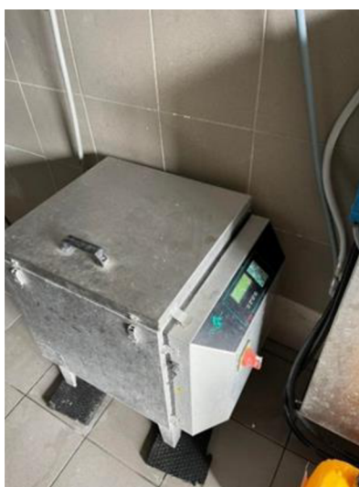
Obrázek 4.1: Stroj na ohřívání mleziva (Wendl, 2023)
