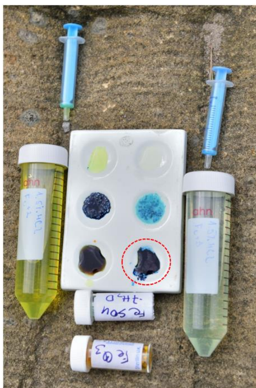
Obr. 13 Kontrolní stanovení přítomnosti oxidačních stavů železa prováděné na porcelánové misce s jamkami. (foto F. Eichler, upraveno autorem)
