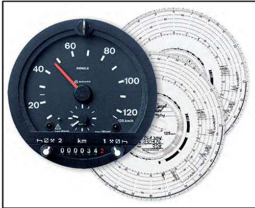
Model tachografu TCO 1311 (Zdroj: VDO Fleet Europe)
