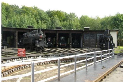
Obrázek č. 5 - Funkční točna určená nejen pro parní lokomotivy
