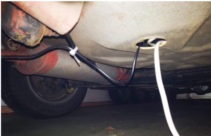
Obrázek 6: Instalace hadic pro výfukovou sondu
