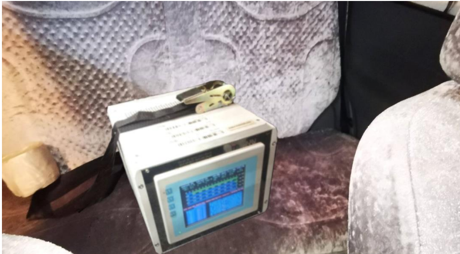
Obrázek 4: Přenosný analyzátor VMK
