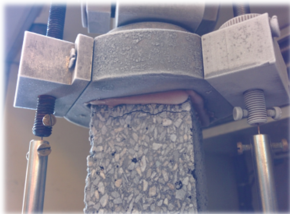
Obr. 12: Porušení vzorku tahovou trhlinou
