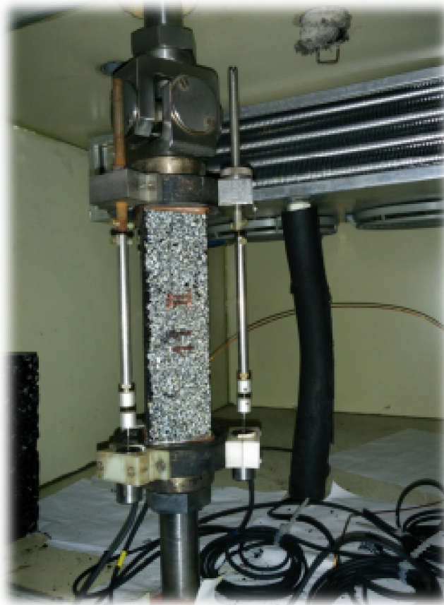
Obr. 10: Upevnění trámečku na spojovací tyč a napojení snímačů
