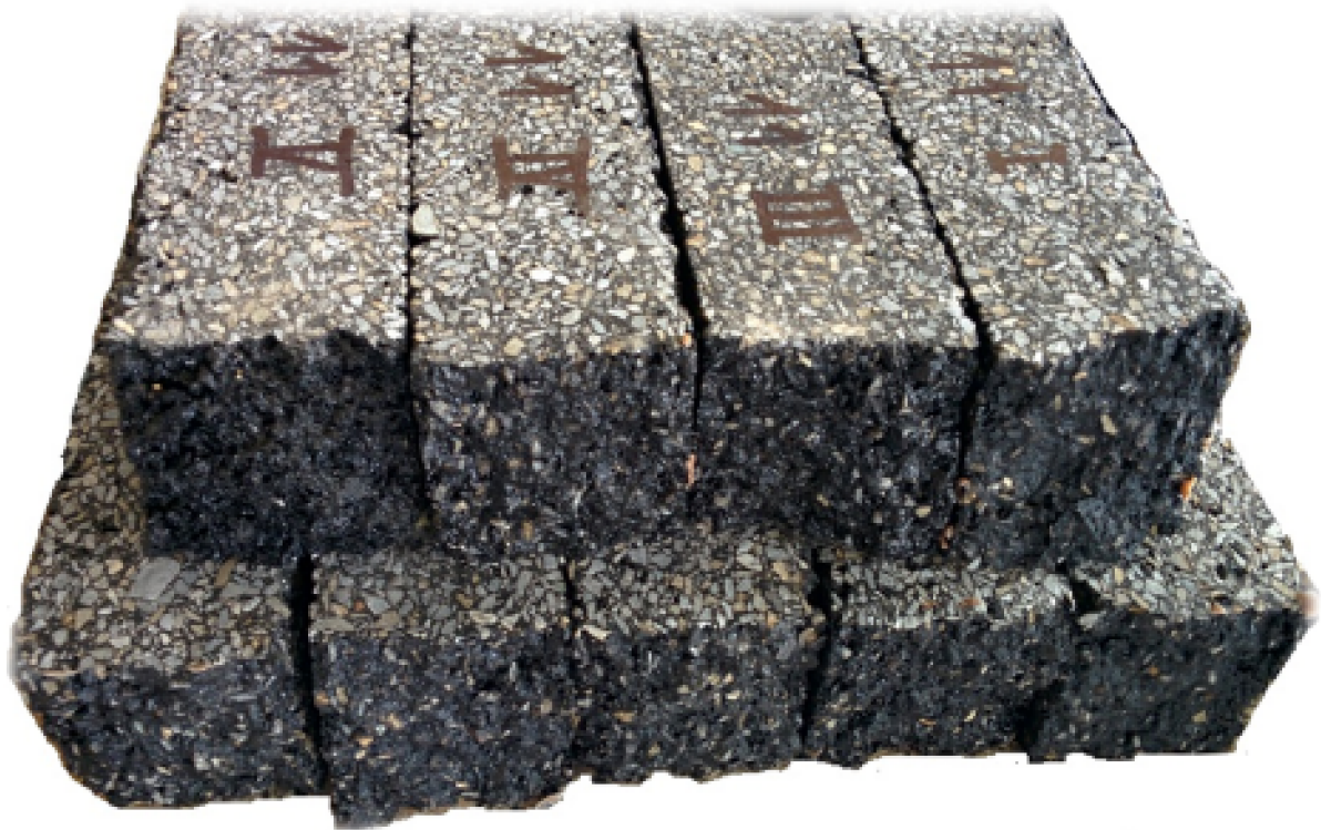
Obr. 13: Porušená zkušební tělesa
