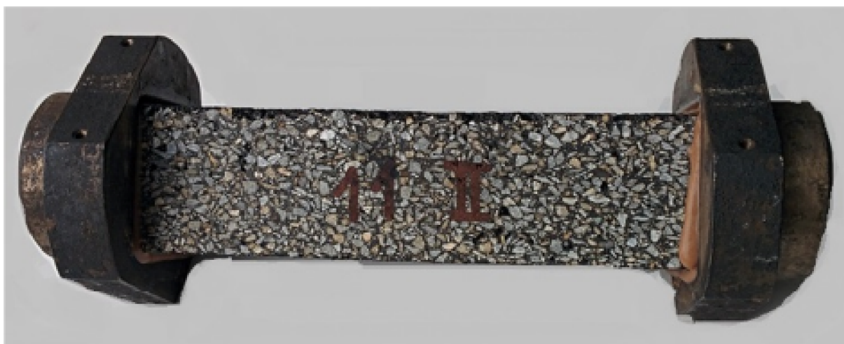
Obr. 9: Zkušební trámeček nalepen v podložkách
