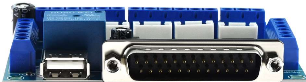
Obrázek 2 - Oddělovací deska, pohled zepředu
