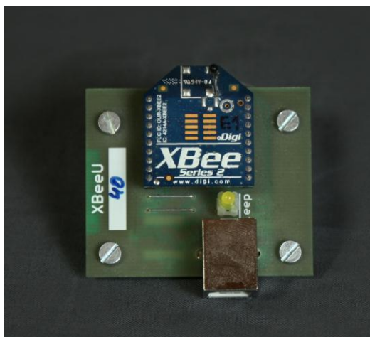
Obr. 6.1 XBee modul spolu s převodníkem UART-USB
