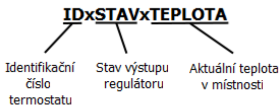
Obr. 6.7 Obsah zprávy vysílané termostatickou jednotkou
