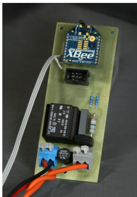
Obr. 10.11 Fotografie hotového výrobku termostatické jednotky
