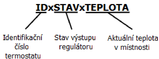
Obr. 6.7 Obsah zprávy vysílané termostatickou jednotkou
