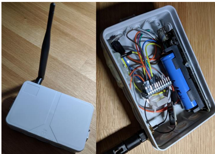
Obrázek 21 - Finální uložení prototypu (vlastní zpracování)
