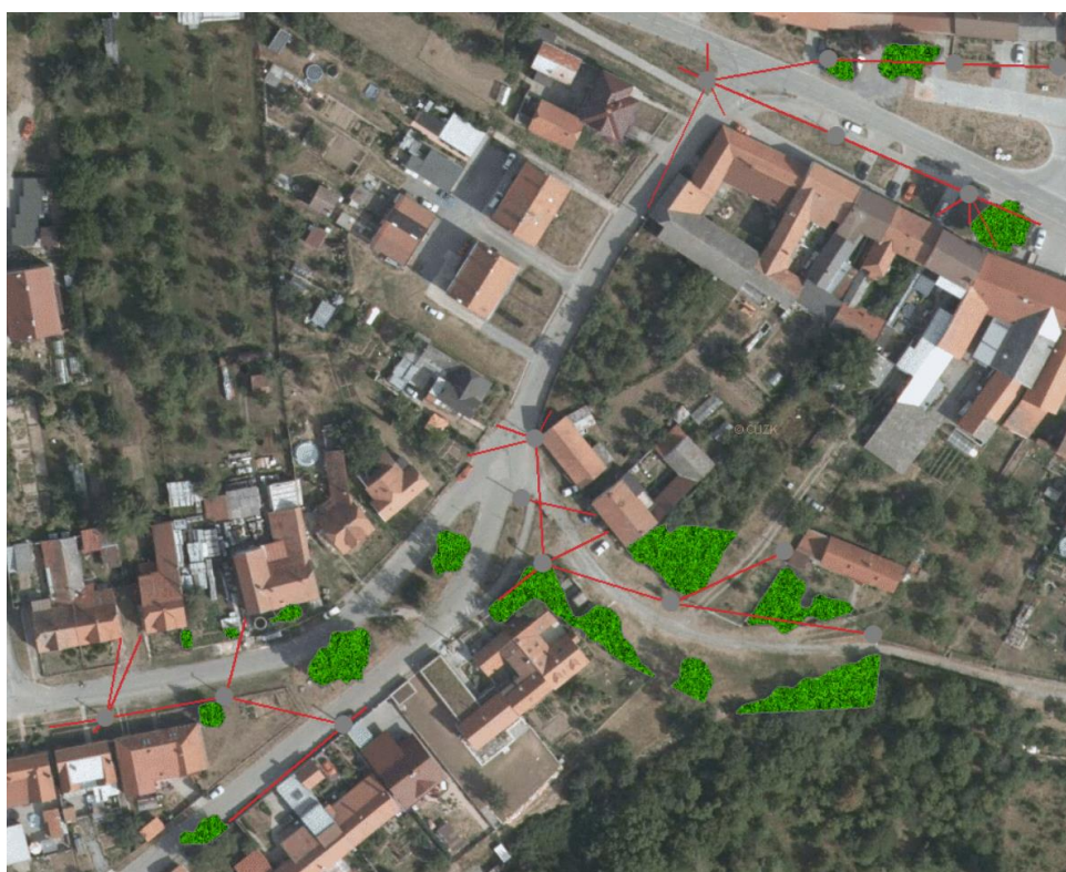
Obr. 5.14 Vizualizace vzdušného vedení, vegetace a sloupů v Ostrově u Macochy
