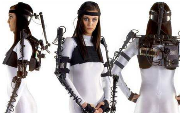
Obrázek č. 32: Mechanické zařízení snímání pohybu (Zdroj: http://www.metamotion.com/gypsy/Gypsy-6-torso.html )
