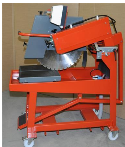
Obr. 3- 39 Stolová kotoučová pila PK 60DS
