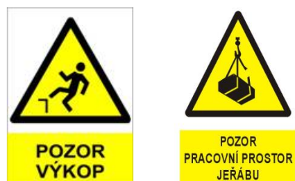
Obr. 2- 13 Značení na staveništi
