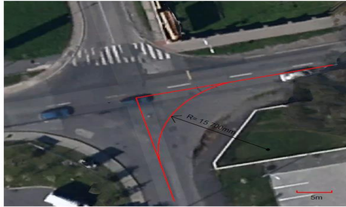
Obr. 4- 12 Bod- 1 Odbočení z ulice Za Avii do ulice Cukrovarská
