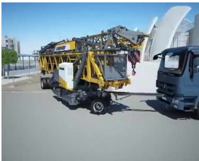
Obr. 4- 28 Přeprava samostavitelného věžového jeřábu Liebherr 71K do směrových oblouků s malým poloměrem
