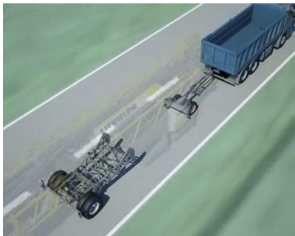
Obr. 4- 1 Přeprava samostavitelného věžového jeřábu Liebherr 71K
