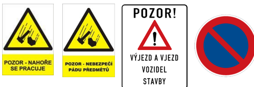
Obr. 4- 30 Značení na komunikacích v blízkosti staveniště
