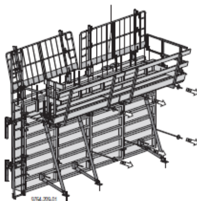
Obr. 5- 18 Začátek odbedňování rámového bednění stěn DOKA Framax Xlife
