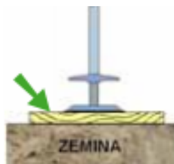
Obr. 7- 2 Svislá nosná část konstrukce lešení umístěna na dřevěné podložce
