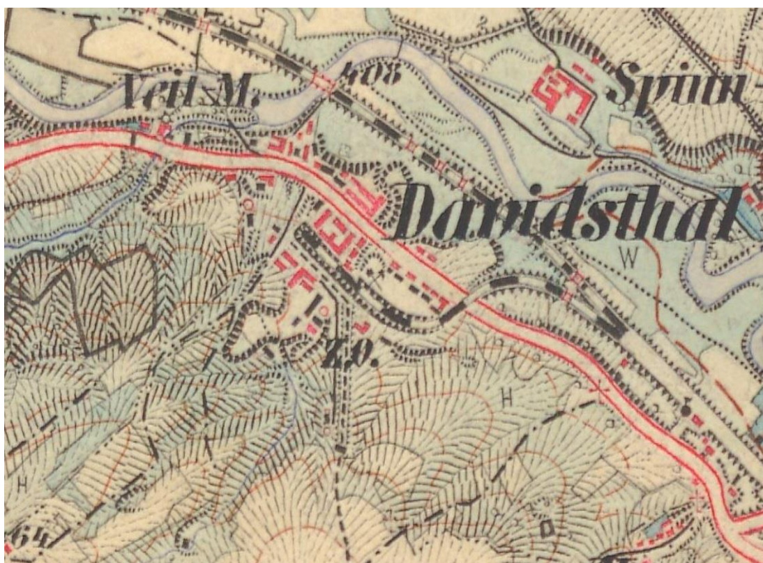
Obr. 15 - III. vojenské (Františko-Josefské) mapování, mapový list 3949_2 – provozní budovy s kolejovou odbočkou umožňující transport vytěženého materiálu k železnici, http://oldmaps.geolab.cz . Výřez.
