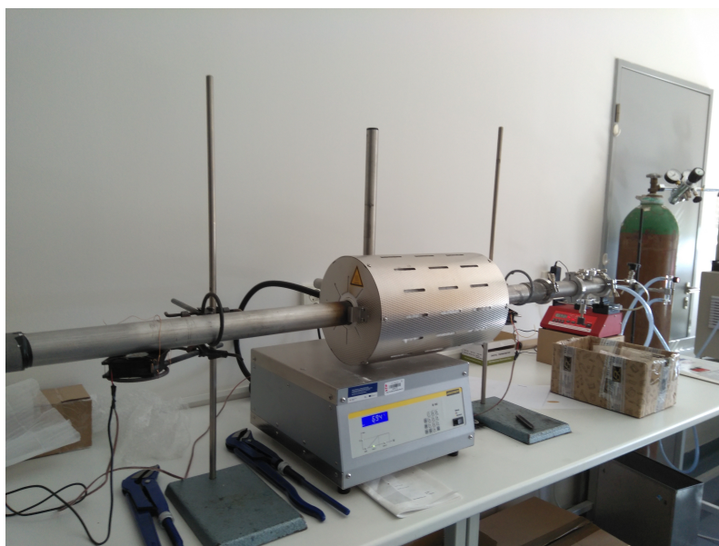
Obrázek 18 | Fotografie experimentální sestavy pro syntézu uhlíkových struktur metodou CVD
