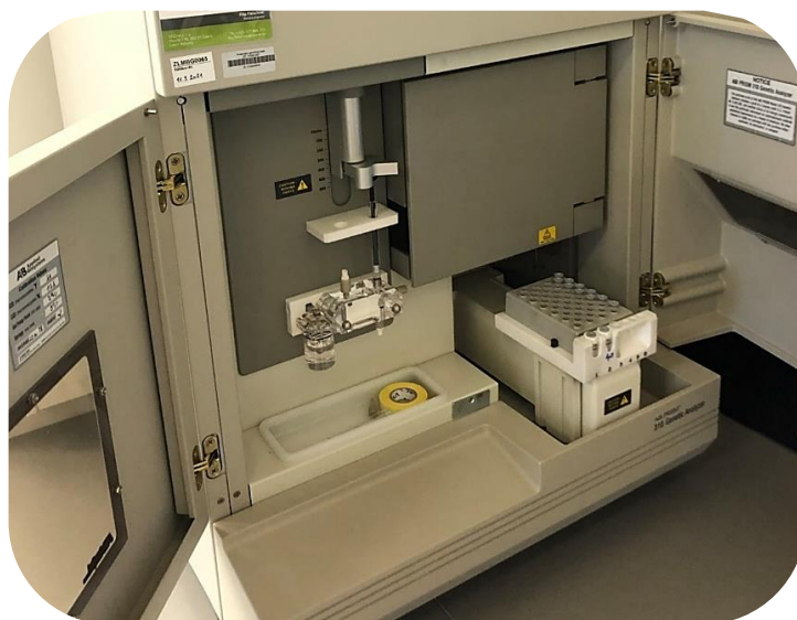
Obrázek 5: Genetický analyzátor ABI310 pro fragmentační analýzu.
