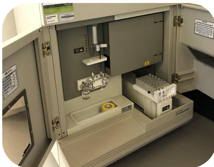
Obrázek 5: Genetický analyzátor ABI310 pro fragmentační analýzu.
