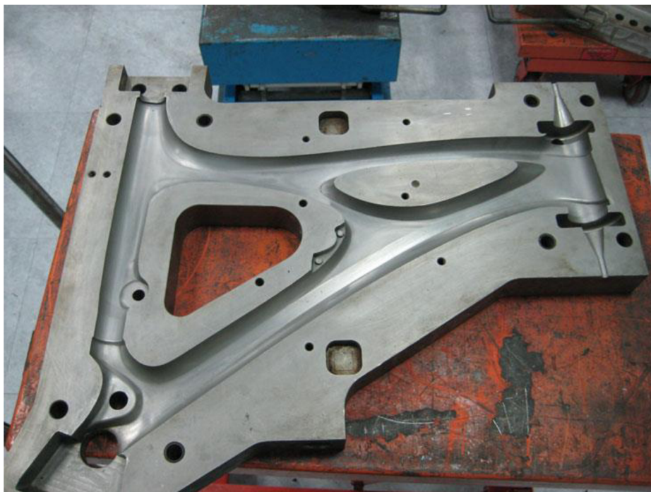
Obr. 3.9 Ukážka jednej polovice z formy, do ktorej sa naukladajú vrstvy karbónu [33]
