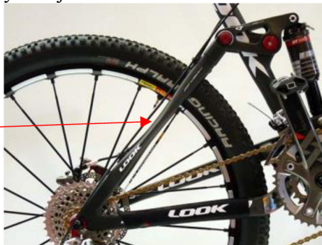
Obr. 4.6 Zadná stavba bicykla 920 od firmy Look s viditeľným miestom zoslabenia. [40]
