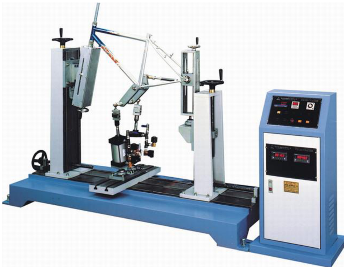
Obr. 2.5 Testovací prípravok rámu bicykla [23]
