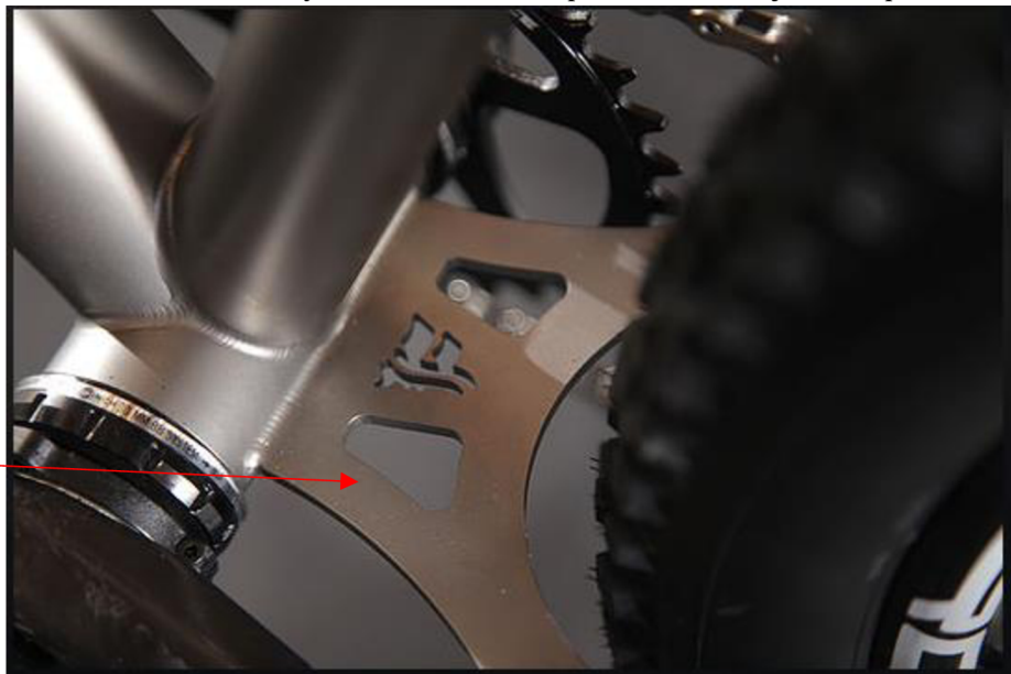
Obr. 4.4 Detailný pohľad na pružný prvok bicykla La Ruta [38]
