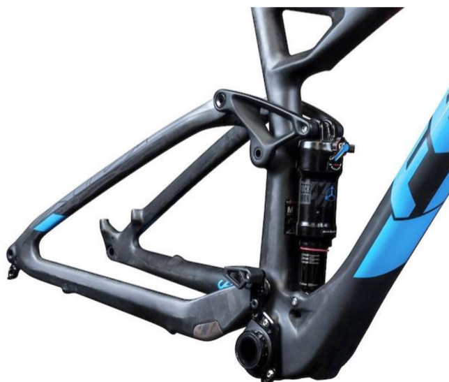
Obr. 4.9 Pohľad na mechanizmus odpruženia bicykla Felt Edict [42]
