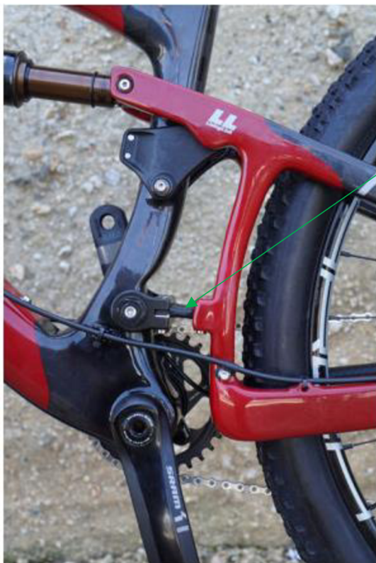
Obr. 4.7 Ukážka systému s dvomi krátkymi členmi a pružným prvkom [41]
