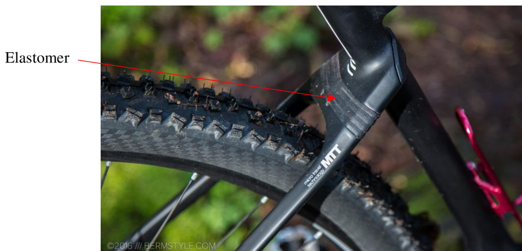
Obr. 4.3 Pohľad na elastomer na vrchu sedlovej vzpery [36]
