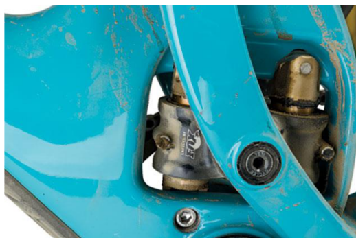
Obr. 1.14 Detailný pohľad posuvnú väzbu zaradenú do systému odpruženia [26]
