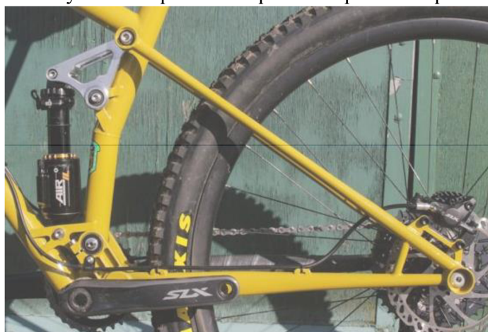
Obr. 4.12 Pohľad na oceľovú zadnú stavbu bicykla s absentujúcou rotačnou väzbou [44]
