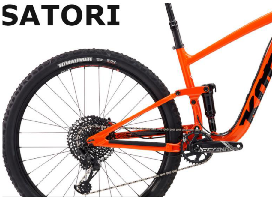
Obr. 4.11 Pohľad na zadnú stavbu s absentujúcou rotačnou väzbou bicykla Kona Satori, ktorý ju má z hliníku [43]
