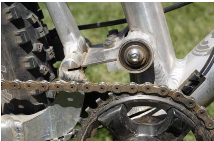
Obr. 4.8 Prototyp daného bicykla s titánovým pružným prvkom [41]
