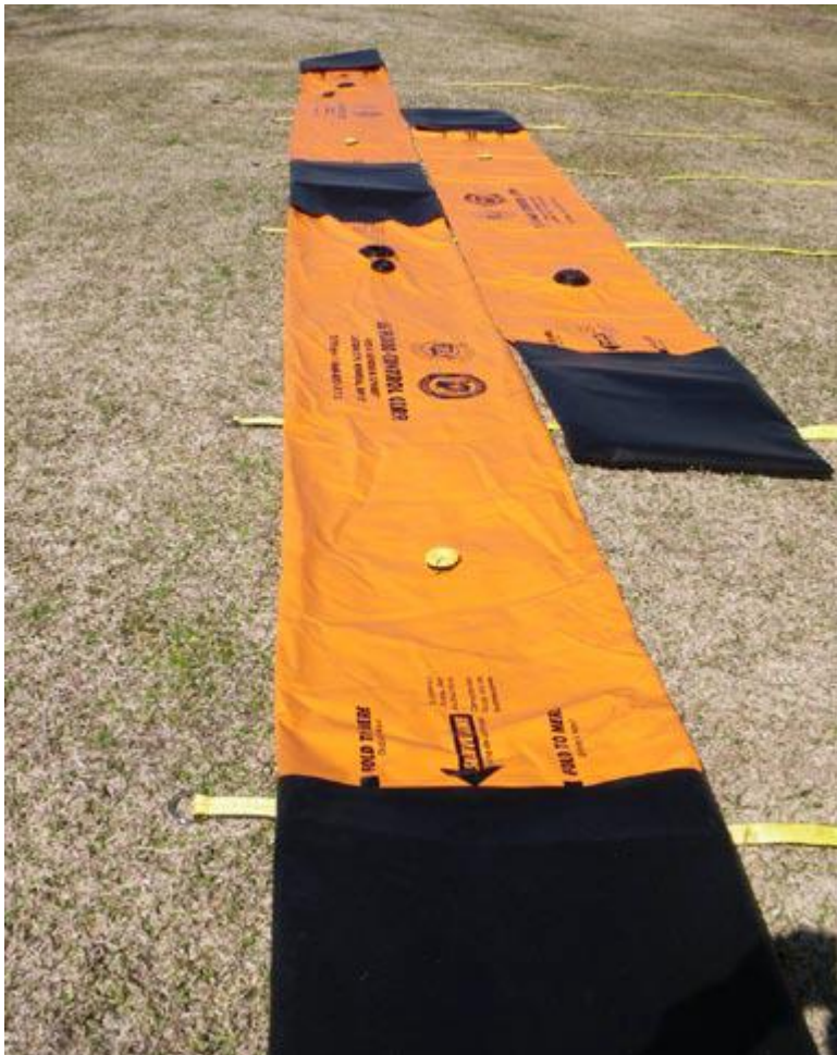
Obr. 7 Vypuštěné tubusy připravené k napuštění, nalevo spojení za pomoci manžety 2 tubusů a jejich utěsnění na koncích také manžetou, napravo samostatný tubus utěsněný na obou koncích manžetou. (Johny Servis, 2009)
