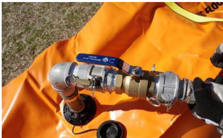
Obr. 8 Napouštění tubusů za pomoci adaptéru na klasické hasičské hadici. (Johny Servis, 2009)
