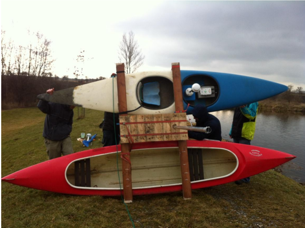
Příloha 4: Měření batymetrie přístrojem River Surveyor M9 a současně tyčí
