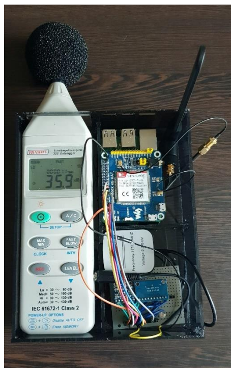
Obrázek 6.8 Měřicí soustava umístěná v ochranném boxu
