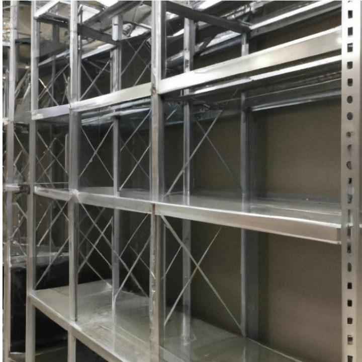
Obrázek 4 Regálová konstrukce ve skladu s přihrádkovými regály
