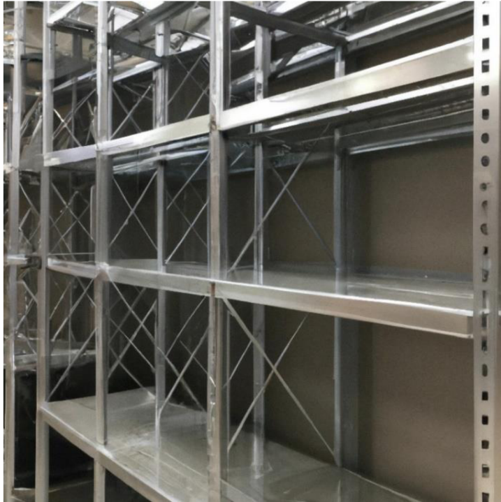
Obrázek 4 Regálová konstrukce ve skladu s přihrádkovými regály
