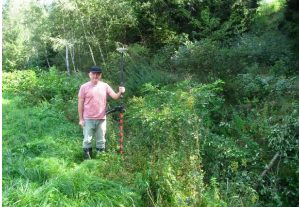
Foto 10: Bc. Václav Kahuda s přístrojem Leica Zeno 20 při zaměřování stávajících stavů koryta vodního toku. (Foto: Václav Kahuda 2017).
