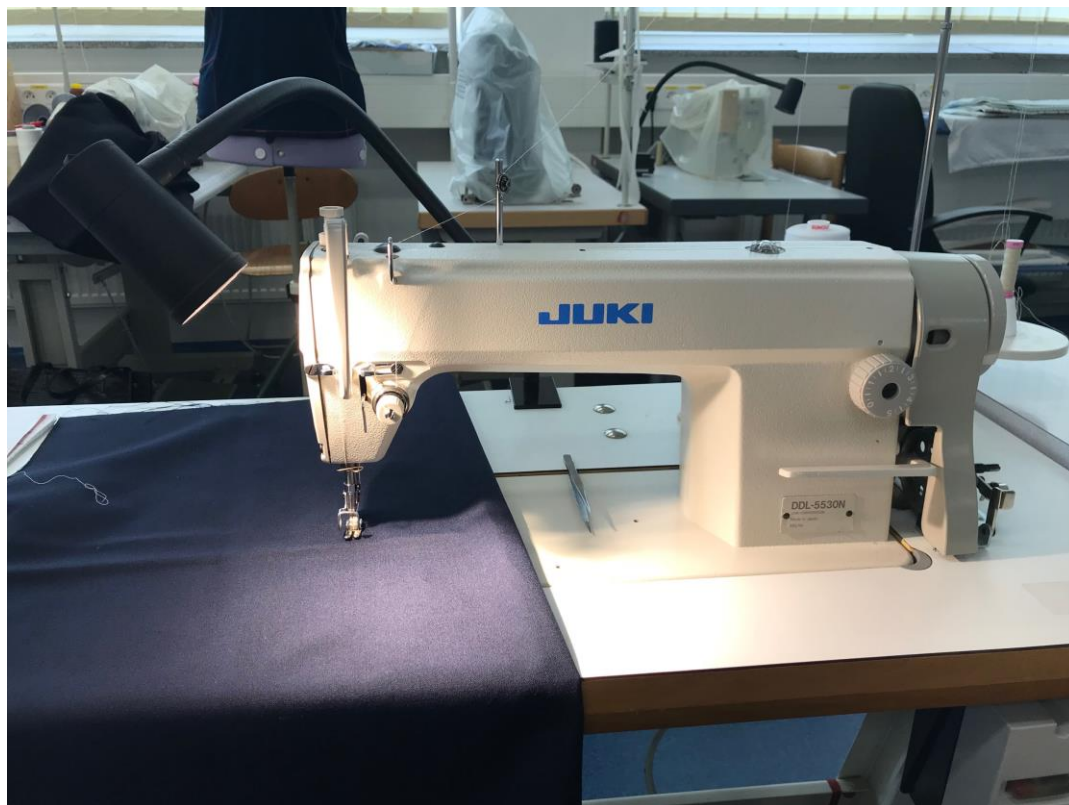
Obr. 5 - Šicí stroj JUKI DDL-5530N s dvounitným vázaným stehem
