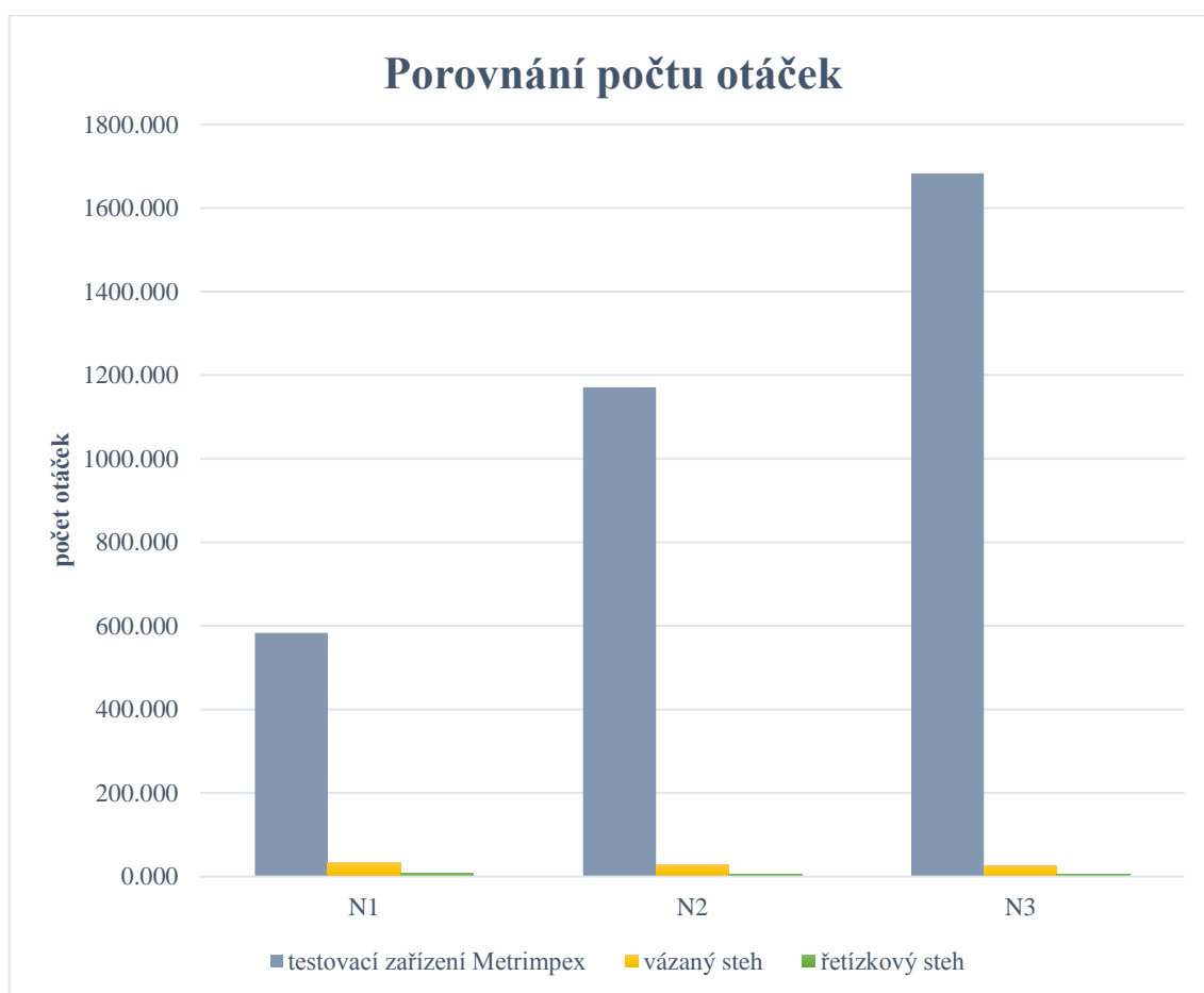
Obr. 11 - Graf srovnávající počet otáček naměřených na testovacích zařízeních
