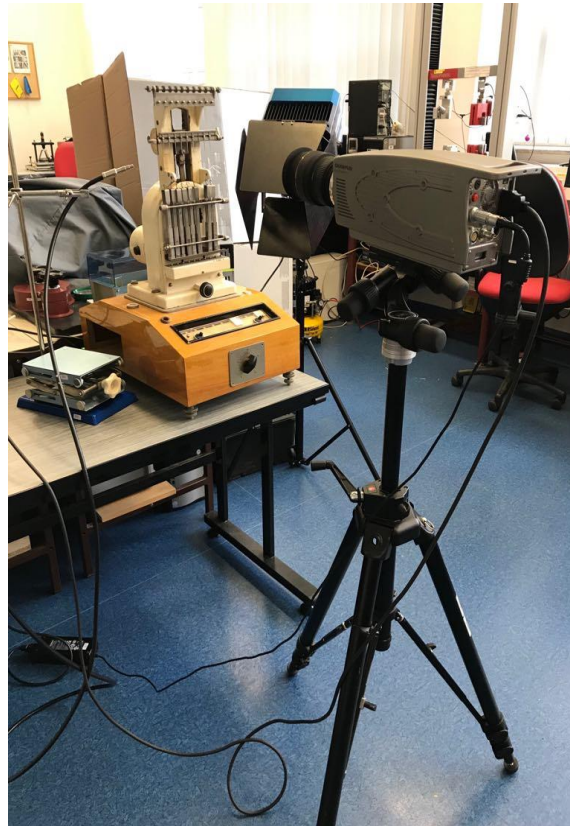
Obr. 10 - Měření počtu otáček rychlokamerou
