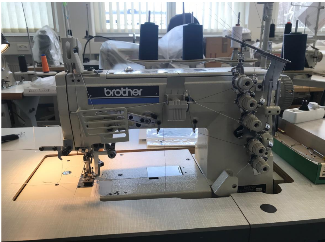
Obr. 7 - Šicí stroj Brother FD4-B272 s oboustranně krycím stehem třídy 600
