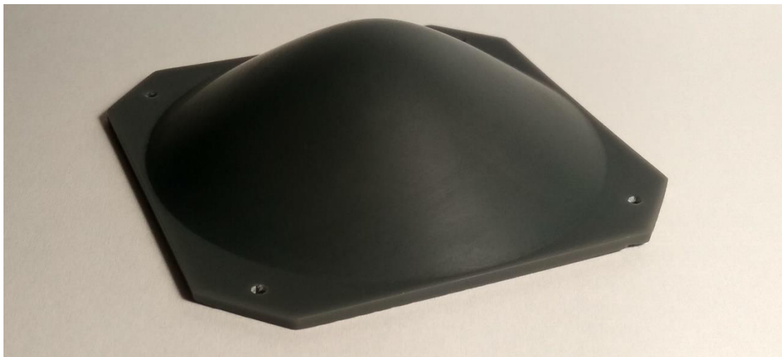
Obrázek 5.1: Čočka z fotopolymeru vyrobená technologií SLA
