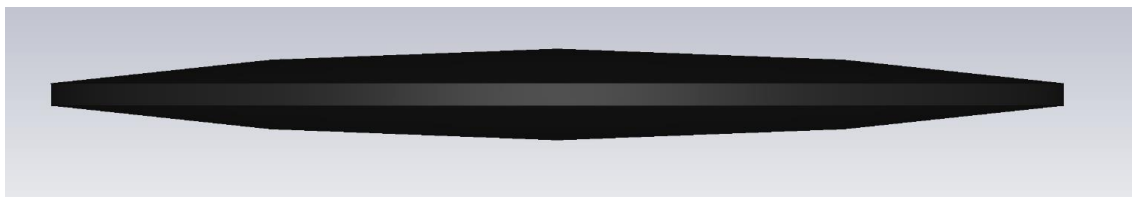
Obrázek 2.15: Navržená sférická dielektrická čočka
