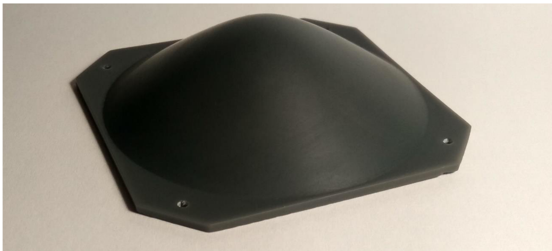
Obrázek 5.1: Čočka z fotopolymeru vyrobená technologií SLA
