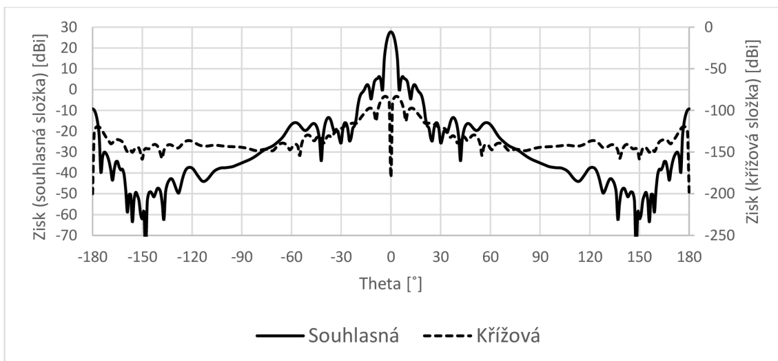
Obrázek 4.22: Směrová charakteristika zisku v E-rovině na kmitočtu 77 GHz čočkové antény s dielektrickou čočkou z ABS
