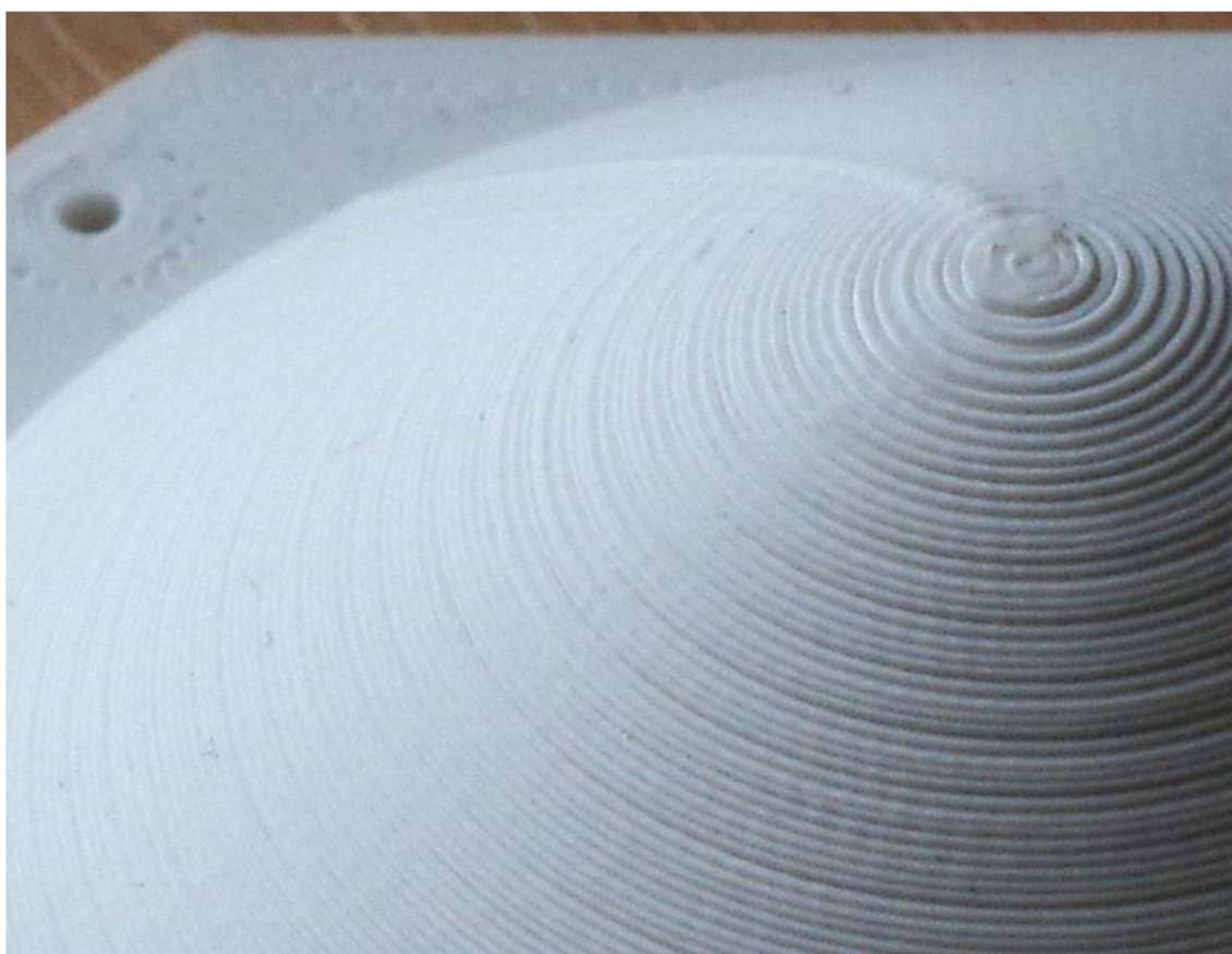
Obrázek 5.5: Detail vrstev na čočce z ABS vyrobené technologií FDM
