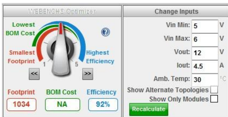
Obr.5: Zadání parametrů do programu WEBENCH® [4]
