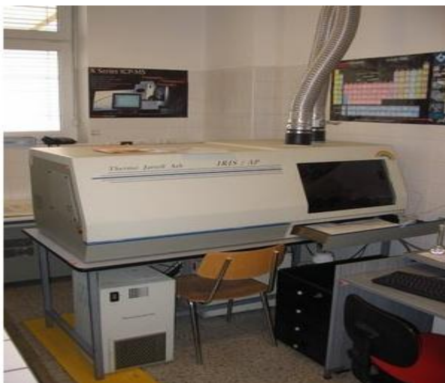
Obrázek 14 Emisní spektrometr s indukčně vázaným plazmatem
