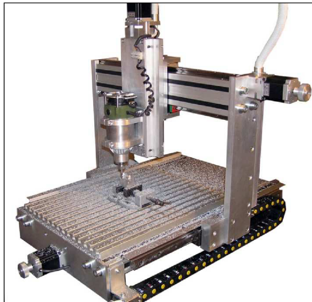
Obr. 6: CNC s pohyblivým portálem [24]
