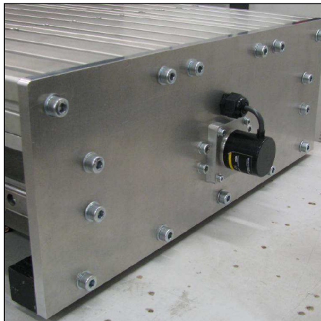
Obr. 68: Umístění snímače polohy osa X
