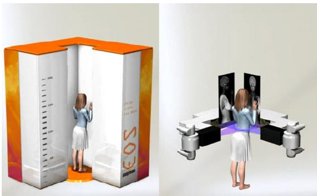
Obrázek 2 – Princip EOS zobrazovacího systému (Illés, 2012)
