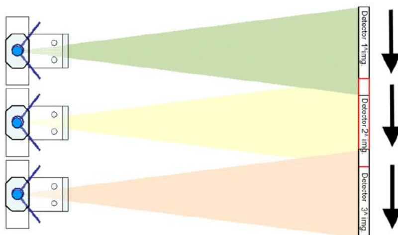
Obrázek 6 – Lineární stitching (Bassi et al., 2013)
