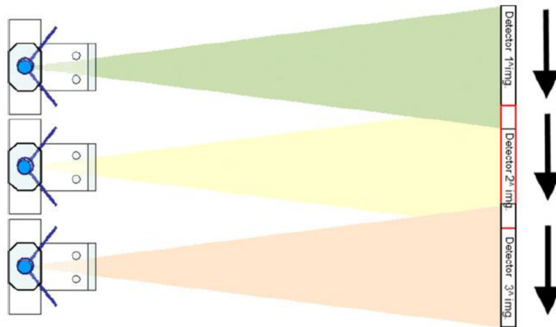
Obrázek 6 – Lineární stitching (Bassi et al., 2013)
