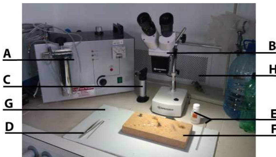
Obr. 13: Pracovisko pre tvrdé spájkovanie
