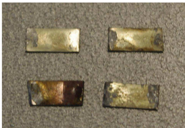
Obr. 20: Zvyšky mäkkej spájky na koncoch súčiastky
