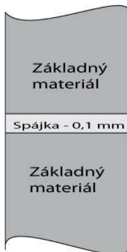
Obr. 4: Medzera medzi spájkovanými časťami
