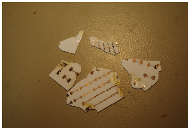
Obr. 16: Prasknutá keramika po veľkom tepelnom zaťažení
