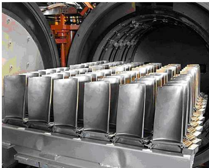
Obr. 10: Vkladanie súčiastok do pece [4]
