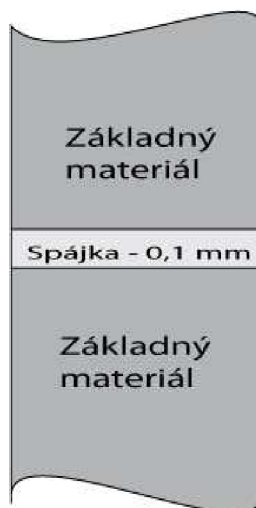
Obr. 4: Medzera medzi spájkovanými časťami
