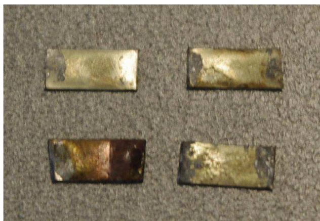
Obr. 20: Zvyšky mäkkej spájky na koncoch súčiastky
