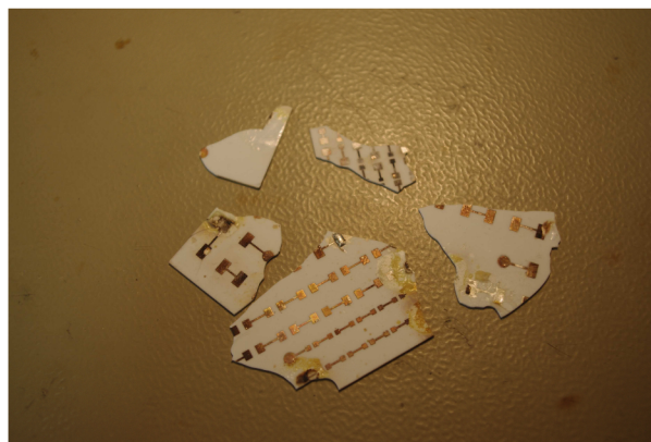
Obr. 16: Prasknutá keramika po veľkom tepelnom zaťažení
