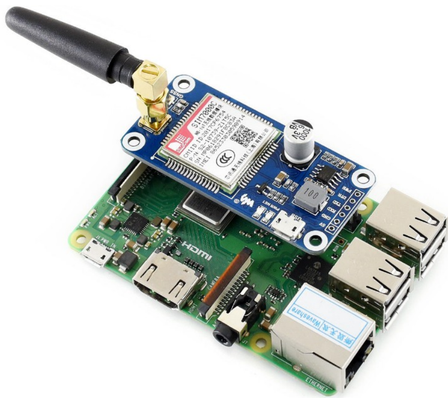
Obrázek 34 Modul pro odesílání dat WS NB-IoT/eMTC/EDGE/GPRS/GNSS HAT for Raspberry Pi SIM7000C (Zdroj: https://www.ebay.com/itm )
