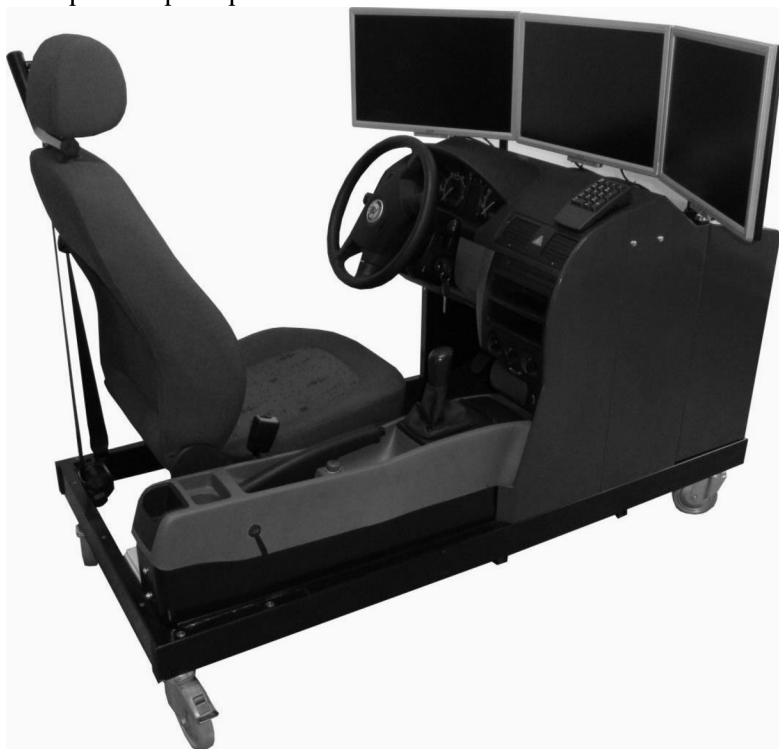
Obrázek 3.1 Automobilový trenažér AT – 208/ VRT firmy JKZ s.r.o.
