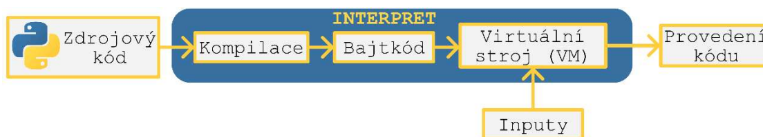
Obr. 1: Schéma interpretace Pythonu
