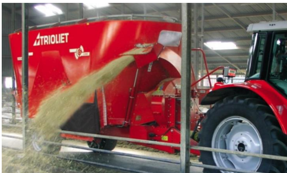
Obrázek č. 6 – MKV s integrovaným zastýlacím zařízením zdroj: http://www.trejon.se/se/trioliet-solomix-p2-turbo-1200zk-rosfri-halmflakt.html
