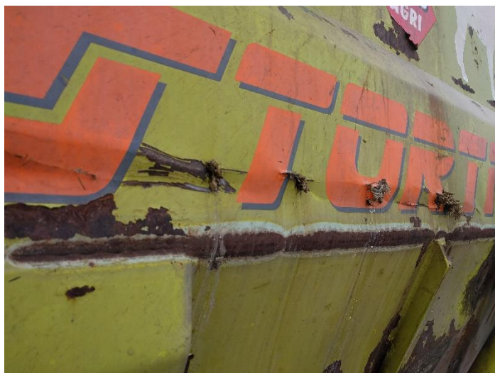
Obrázek č. 22 – Poškození vany od míchacího šneku Zdroj: autor
