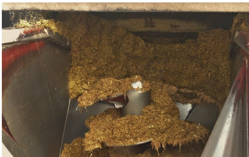
Obrázek č. 18 – Problém se zaseknutým krmivem zdroj: autor
