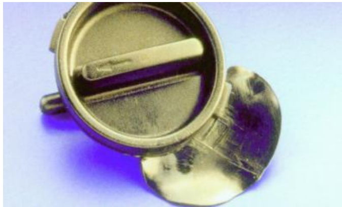
Obr. 25 Přetok na výstřiku [30]
