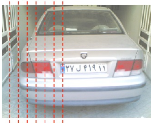
Obrázek 3.8: Vertikální vyhledávání značky. Převzato z [1].
