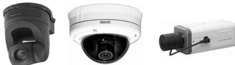
Obr. 2.1: Typické tvary průmyslových kamer. Zleva auto-dome, dome, standard [8]
