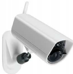
Obr. 2.4: Typický tvar GSM bezpečnostní kamery [8]
