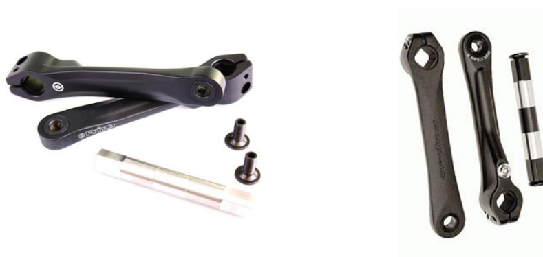
Obrázek 6. Porovnání klik Hollowbite s titanovou osou a Powerbite s ocelovou osou
