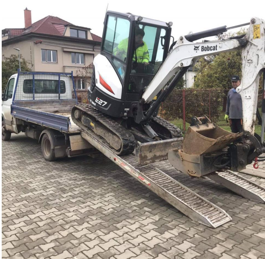
Obrázek 23 - Převoz stavebních strojů
