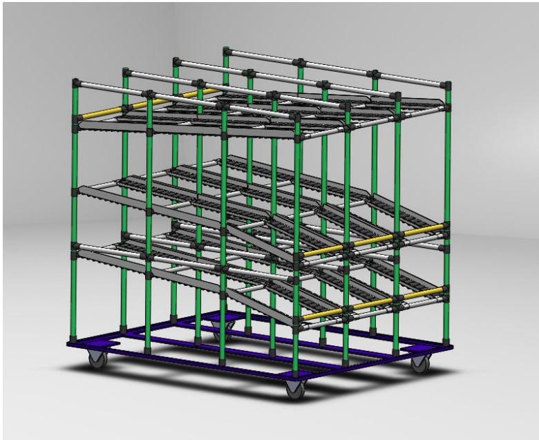
Obr. 3.5 Spádový (trubkový) regál u montážní linky
