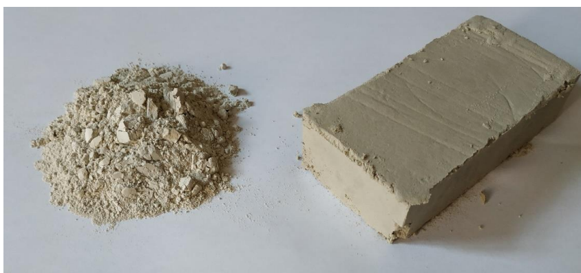
Obr. 9 – Výchozí surovina Dolmag P frakce pod 0,090 před výpalem
