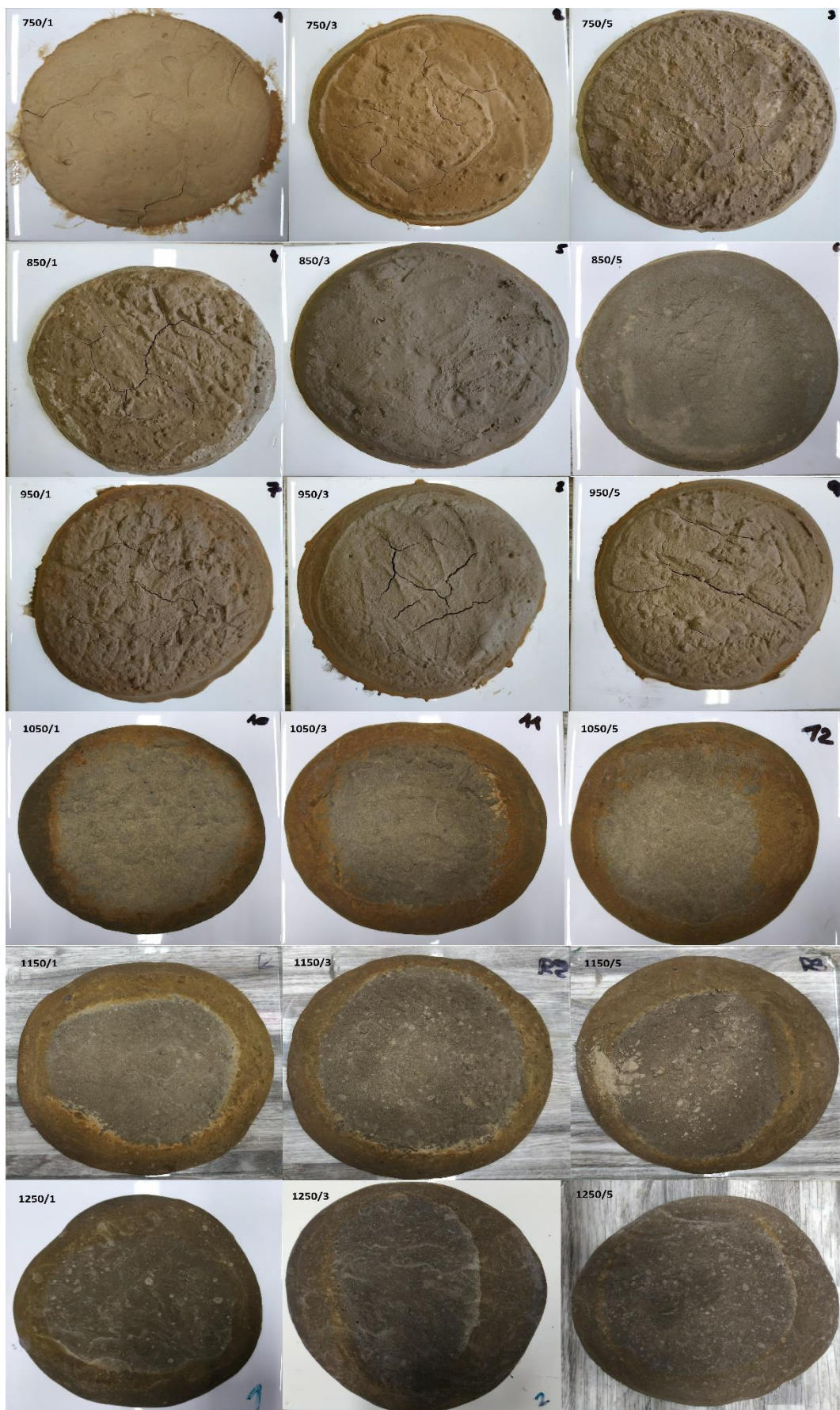
Obr. 46 – Fotografie koláčkové zkoušky v době expozice 7 dnů
