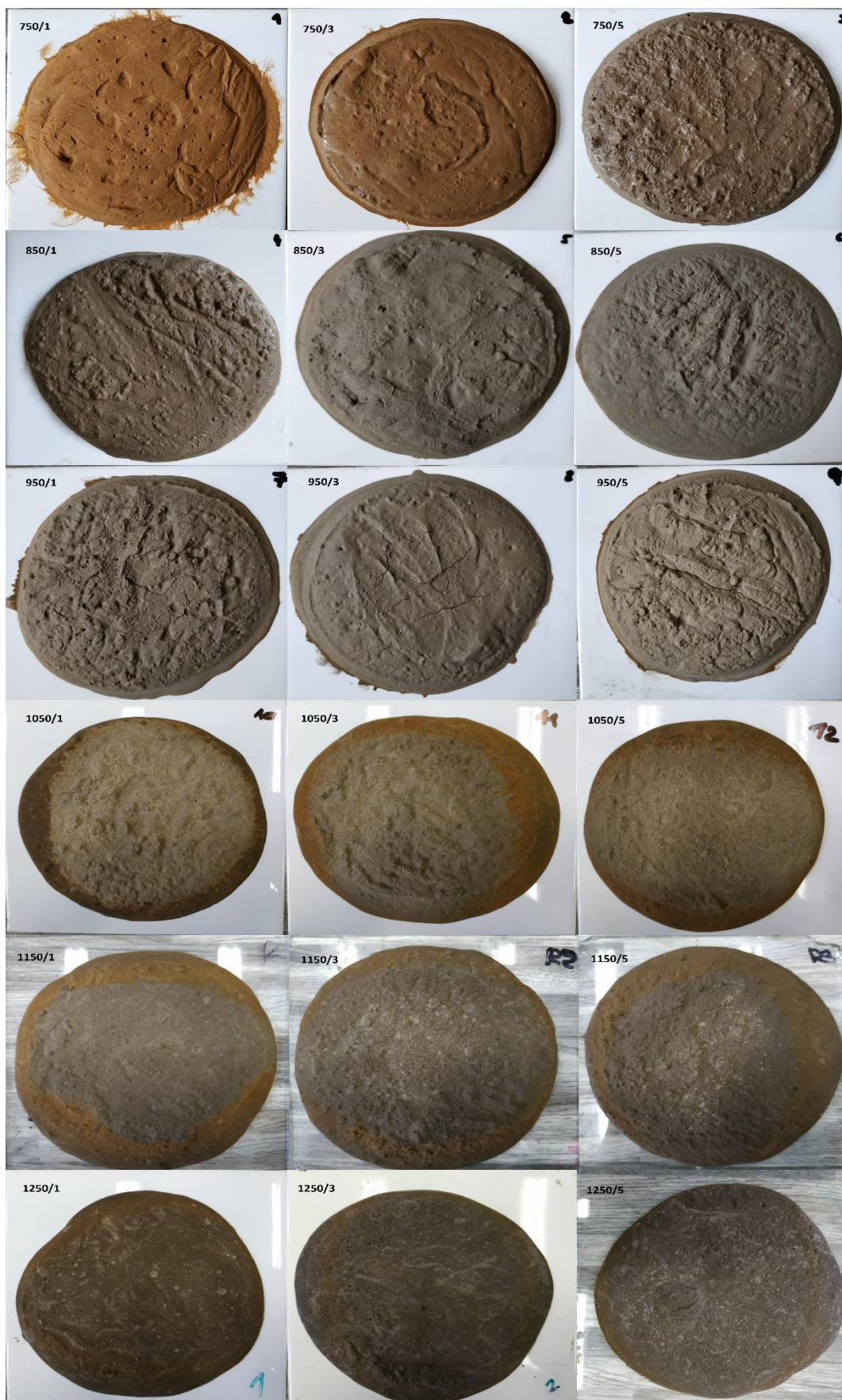
Obr. 45 – Fotografie koláčkové zkoušky v době expozice 1 den
